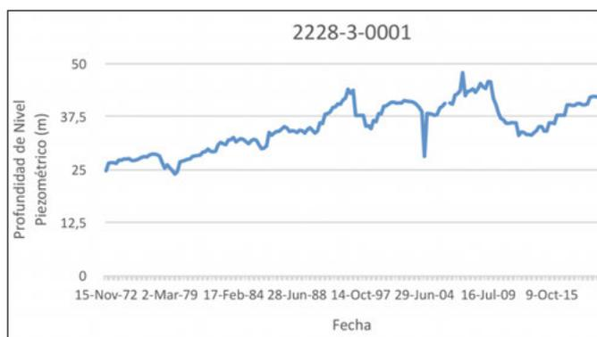
Evolución de la profundidad de nivel piezométrico en el sondeo 2228-3-0001.
